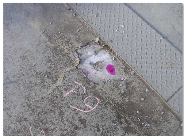
Obrázek 4a: Zkouška přídržnosti na vyrovnávací stěře
