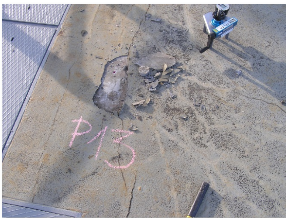
Obrázek 7a: Orientační odtrh stěrky
