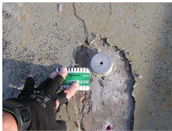
Obrázek 8a: Trhlinka procházející až do žb. desky
