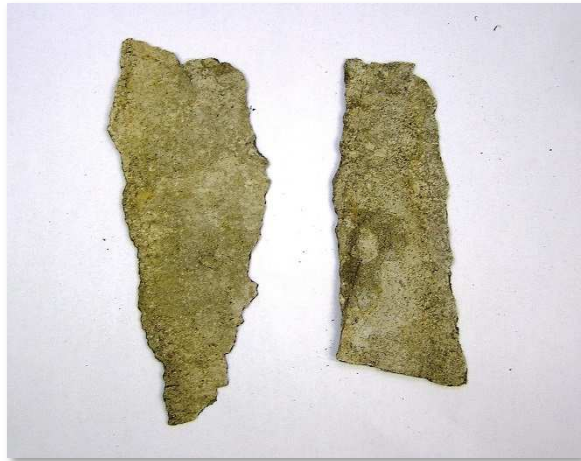
Obrázek 14c: Spodní povrch oddělené stěrky
