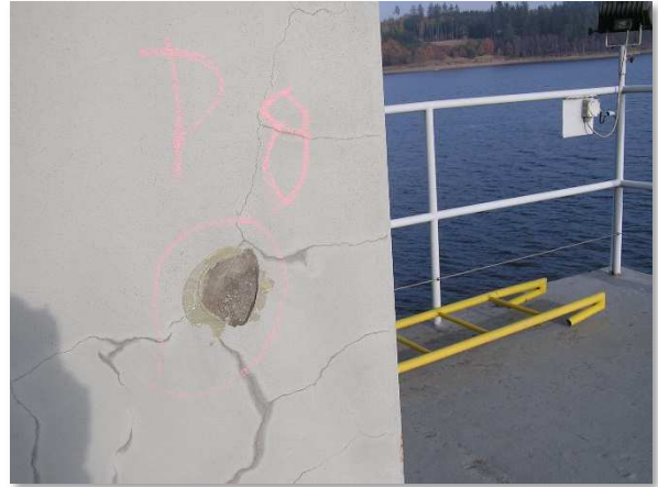
Obrázek 6b: Zkouška přídržnosti stěrky sloupu 5
