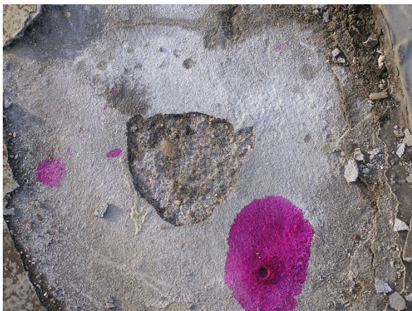
Obrázek 5a: Karbonatace betonu a betonový podklad pod stěrkou
